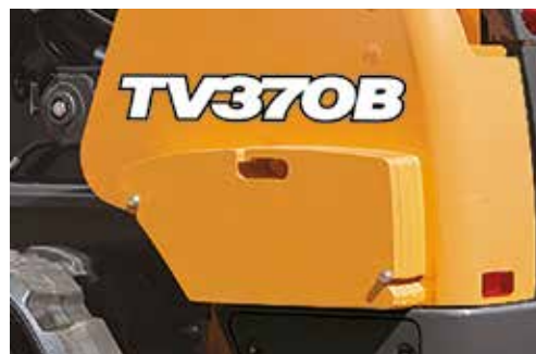
Dodatkowa przeciwwaga dla zwiększenia udźwigu.
