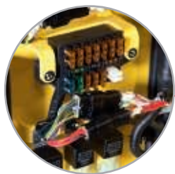
Centralna skrzynka bezpiecznikowa ułatwiająca kontrolę
